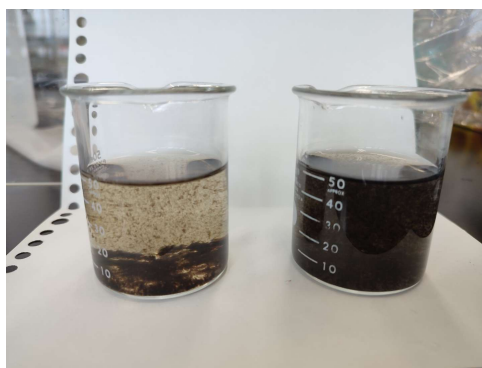
【写真1】沈殿の発生
